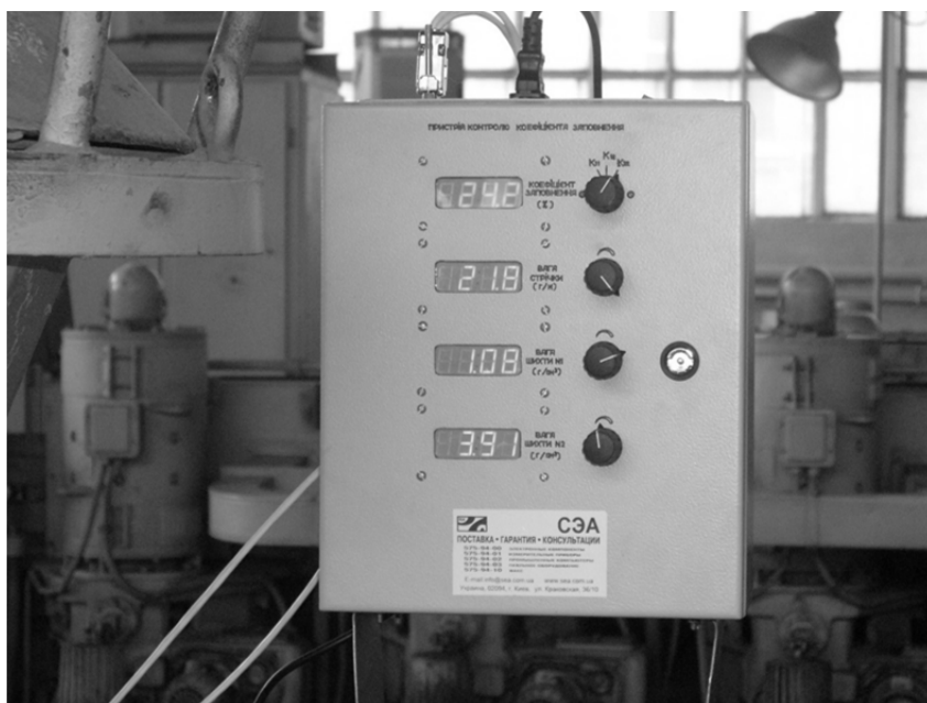
Рис. 2. Опытно-промышленный образец прибора индикации заполнения порошковой проволоки на технологической линии.
